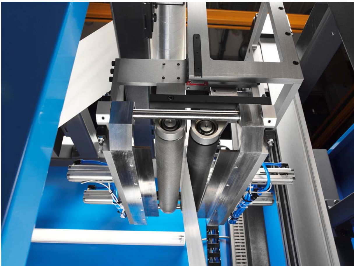
Unité de transfert de coupe de ciseaux dans le groupe d'enroulement non-stop „UR Precision“ de Kocher + Beck
